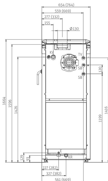
Höhe drehbarer Abgasanschluss (Ansicht von vorne)
